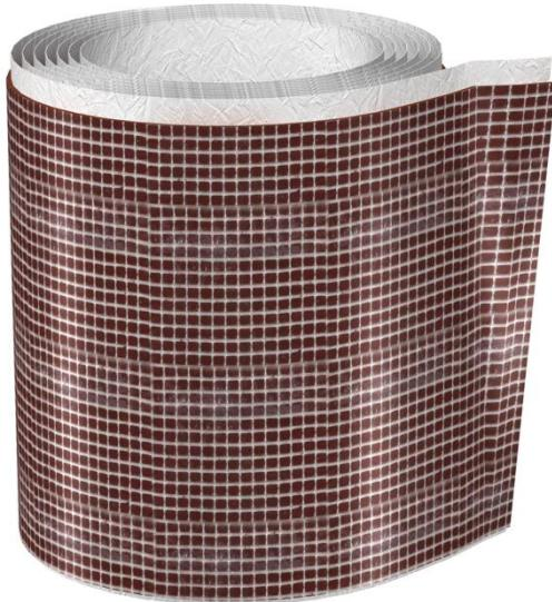
Bandage intumescent autoadhésif, de 5 mm d'épaisseur pour une utilisation avec des câbles de grand diamètre et sur des systèmes de support de câbles ; utilisable avec les systèmes PYROPLUG® et PYROSIT® NG. Utilisation en intérieur.
