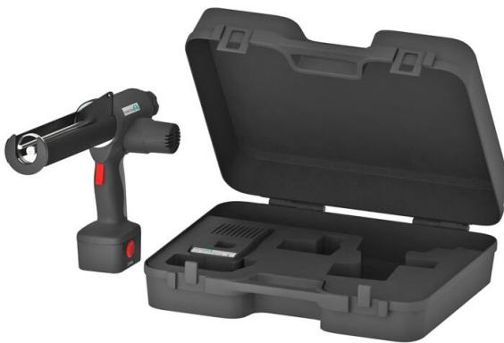
Pistolet à cartouche motorisé professionnel pour mousse coupe-feu bicomposant PYROSIT® NG. Convient aux cartouches coaxiales 5:1. Les pièces mobiles, les tiges de poussée et les plaques de pression doivent être débarrassées des éventuels résidus de mousse et entretenues avec un produit nettoyant regraissant.
