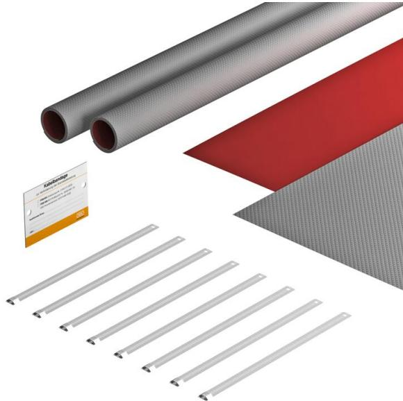
Kit complet d'enrubannage coupe-feu pour botte de câbles ou chemin de câbles sans couvercle afin de prévenir la propagation du feu. Application pour l'extérieur. Chaque kit contient 4 segments d'enrubannage résistant aux intempéries PYROWRAP® Wet, 8 colliers de serrage métalliques et une plaque d'identification. Quantité suffisante pour enruber une longueur d'environ 2 m de chemin de câble.
