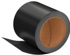
Bandage de protection pare-feu enduite des deux côtés d'un matériau moussant en cas d'incendie à enrouler autour des installations dans les cloisons à base de mortier PYROMIX® et les cloisons en panneaux en fibre PYROPLATE®. Le tissu de support est équipé des deux côtés de la couche qui forme l'isolant. L'épaisseur nominale est de 1,5 mm.
