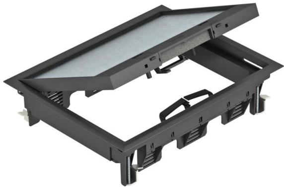
Boîtier de sol avec coulisseau d'arrêt pour 9 appareillages individuels Modul 45 au maximum dans 3 supports universels UT3, insertion dans les systèmes de goulottes et dans les faux planchers à l'intérieur.
