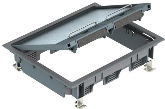
Installation pour 6 accessoires dans 3 supports universels UT pour une utilisation dans des planchers surélevés. Équerre de fixation avec une plage de serrage jusqu'à 50 mm d'épaisseur de plaque.
