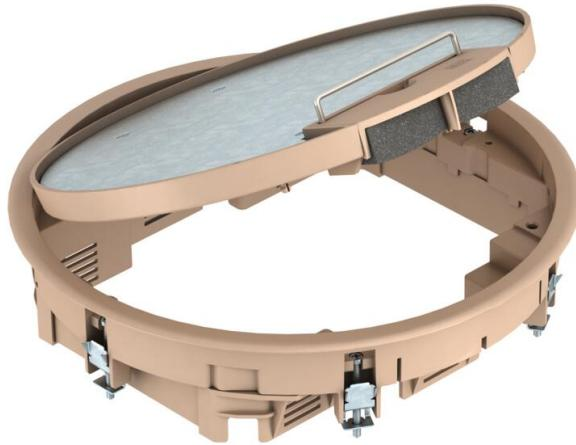
Boîtier de sol avec poignée étrier pour 10 appareillages individuels Modul 45 maximum sur 2 supports universels UT3 et un support universel UT4, insertion dans les systèmes de conduits et les faux planchers en intérieur. Possibilité d'utiliser jusqu'à 7 appareillages d'installation avec une plaque centrale de 50.
