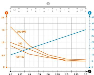
Diagramme de charge du chemin de câbles en treillis type GRM 105
