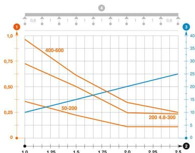
Diagramme de charge chemin de câbles en treillis type GRM 55 VA
