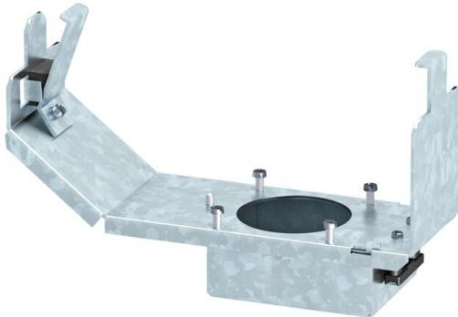
Support d'appareillage de taille nominale 3 pour le montage d'une prise CEE 16 A ou 32 A à monter dans des boîtiers de sol et cassettes de dimension R7, 9 et R9. Support d'appareillages avec boîtier de protection et décharge de traction. Profondeur minimale requise : 190 mm en cas d'utilisation d'une fiche droite et 160 mm en cas d'utilisation d'une fiche coudée.
