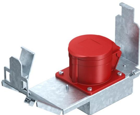
Support d'appareillage de taille nominale 3 avec connecteur CEE 16 A à monter dans des boîtes de sol et des cassettes de tailles nominales R7, 9 et R9. Support d'appareillages avec boîtier de protection et décharge de traction. Profondeur minimale requise : 190 mm en cas d'utilisation d'une fiche droite et 160 mm en cas d'utilisation d'une fiche coudée.
