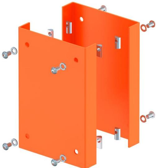
Protection anticollision comme protection mécanique de la colonne industrielle ISS au niveau du sol. Sont inclus dans les fournitures 2 profilés de protection en U, en tôle d'acier de 3 mm et 8 vis de fixation avec clavettes rainurées pour montage sur profil de colonne.
