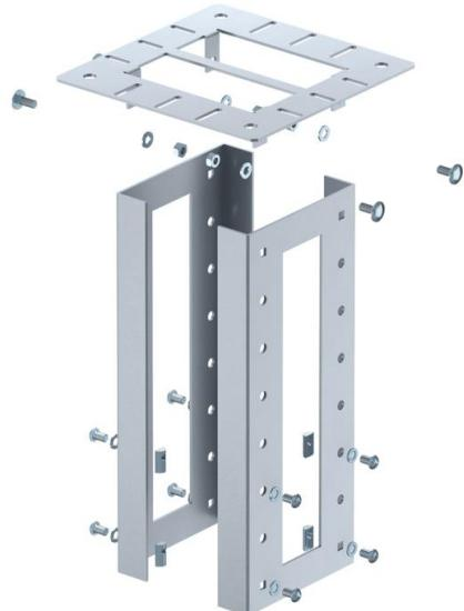
Fixation de plafond pour montage de la colonne industrielle ISS au plafond. Sont inclus dans les fournitures 2 profilés en U en tôle d'acier de 3 mm, la plaque de fixation pour montage au plafond et les accessoires de montage nécessaires avec clavettes rainurées. Le montage au plafond est réglable en hauteur au niveau du profil de colonne.
