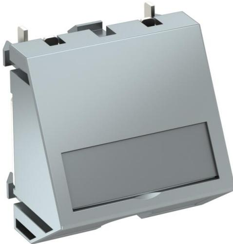
Sortie de câble en 2 parties avec zone de marquage, composée d'un porte-câbles avec décharge de traction et d'un couvercle. La décharge de traction est conçue pour un diamètre de câble de 3-11 mm. La fixation à encliquer convient pour le montage horizontal et vertical dans l'environnement du système.
