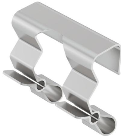
La liaison équipotentielle fonctionnelle du système de support de câble peut être établie avec le ressort de serrage. Le ressort de serrage est serré sur le bord du chemin de câbles et le câble conducteur est ensuite serré dans le réceptacle prévu du ressort de serrage.
