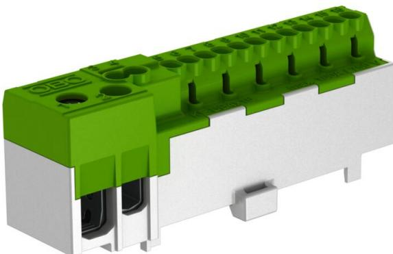
Borne de raccordement neutre en laiton avec 12 points de serrage à fiche 2,5 mm<sup>2</sup> ou 1,5 mm<sup>2</sup> flexibles avec embout d'extrémité ; deux points de serrage à fiche 4 mm<sup>2</sup> ou 2,5 mm<sup>2</sup> flexibles avec embout d'extrémité et deux points de serrage à vis jusqu'à 25 mm<sup>2</sup> ou 16 mm<sup>2</sup> flexibles, 3 Nm.
