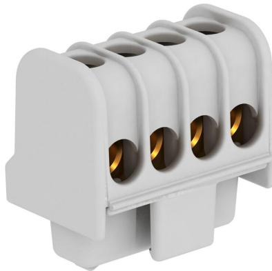
Bornes en laiton, vis en acier, zinguées et passivées de manière transparente, section nominale 6 à 16 mm<sup>2</sup>, tension nominale 400 V, unipolaire, avec bornes femelles max. conducteurs connectables par borne max. 4x16 mm<sup>2</sup>, 4x10 mm<sup>2</sup>, 8x6 mm<sup>2</sup> ou 12x4 mm<sup>2</sup>.
