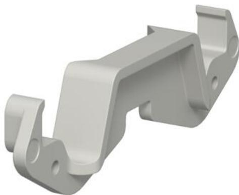
Clip raidisseur pour un maintien fiable des câbles et pour la fixation du séparateur dans les systèmes de goulottes d'appareillage Rapid 80 GK, GS et GA ainsi que dans les colonnes de distribution ISS avec ouverture système de 76,5 mm.
