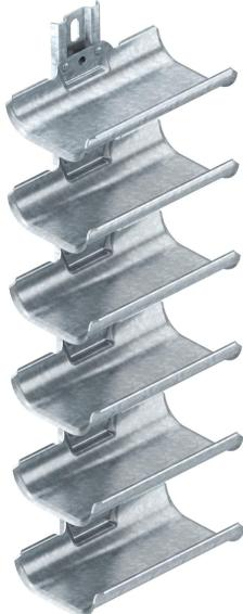
Les gouttières support de câbles sont destinées à une pose simple et rapide dans des zones n'offrant pas un espace suffisant pour montage de systèmes de support de câbles courants. Les gouttières support de câbles dispose d'une grande surface d'appui et de bords extérieurs arrondis pour protéger les câbles. Conformément à la norme DIN VDE 0298-300, ne pas dépasser un écart max. d'appui de 0,8 mm.
