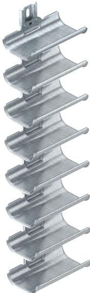
Les gouttières support de câbles sont destinées à une pose simple et rapide dans des zones n'offrant pas un espace suffisant pour montage de systèmes de support de câbles courants. Les gouttières support de câbles dispose d'une grande surface d'appui et de bords extérieurs arrondis pour protéger les câbles. Conformément à la norme DIN VDE 0298-300, ne pas dépasser un écart max. d'appui de 0,8 mm.
