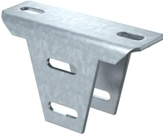
Plaque de tête variable pour le montage sur des montants US 5. En association avec le montant US 5, toutes les longueurs de pendants peuvent être fabriquées sur place. Avec la plaque de tête variable, il est possible de compenser les suspensions inclinées jusqu'à 30°.
