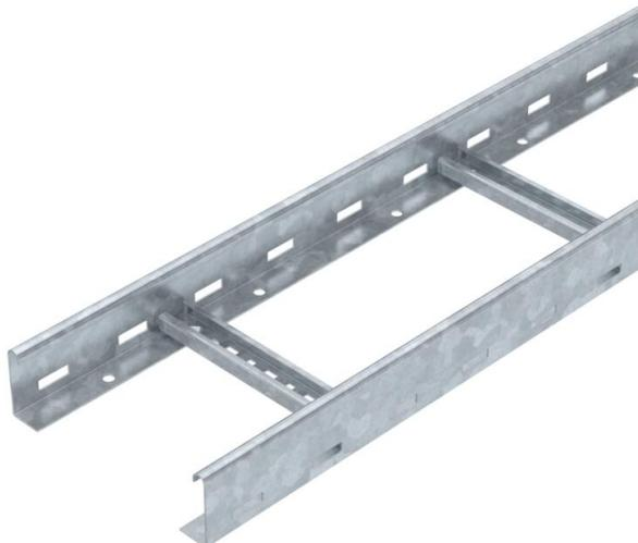
Échelle à câbles d'une hauteur latérale de 60 mm avec échelons soudés à profilé C30 ouvert vers le haut. Longerons latéraux enroulés pour le renforcement et la protection des bords. La fixation sur console s'effectue avec des pièces de serrage de type LKS 40. La fente de l'échelon mesure 16,5 mm. La bride de fixation correspondante est de type 2056.
