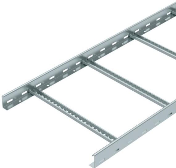
Échelle à câbles d'une hauteur latérale de 60 mm avec échelons soudés à profilé C30 ouvert vers le haut. Longerons latéraux enroulés pour le renforcement et la protection des bords. La fixation sur console s'effectue avec des pièces de serrage de type LKS 40. La fente de l'échelon mesure 16,5 mm. La bride de fixation correspondante est de type BS-H....
