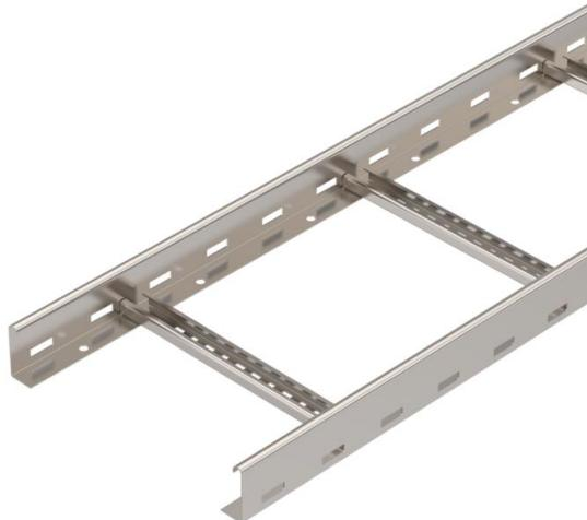
Échelle à câbles avec longeron perforé d'une hauteur de 60 mm, avec échelons VS rivetés (profilé en C) ouverts vers le haut.
