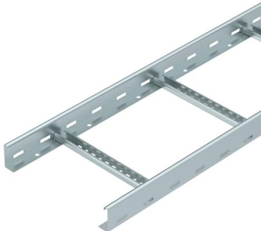
Échelle à câbles avec ailes perforée d'une hauteur de 60 mm, avec échelons VS rivetés (profilé en C) ouverts vers le haut.
