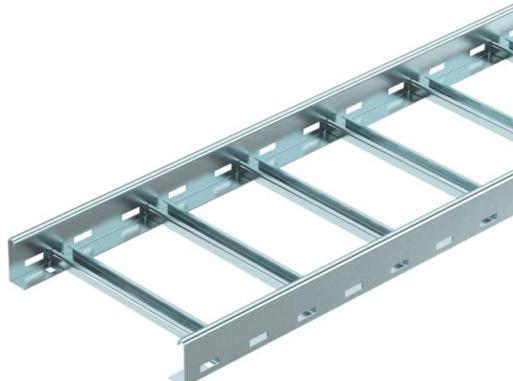
Échelle de câbles pour la pose horizontale de câbles et de fils. Peut être employé comme structure porteuse normalisée pour le maintien en fonction selon DIN 4102 partie 12 Classes de maintien en fonction E30 à E90. Avec un échelon profilé en C riveté et ouvert en haut.
