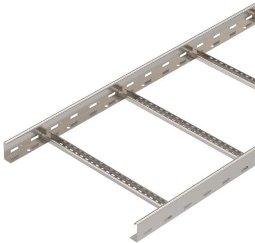
Échelle à câbles avec longeron perforé d'une hauteur de 60 mm, avec échelons VS rivetés (profilé en C) ouverts vers le haut.
