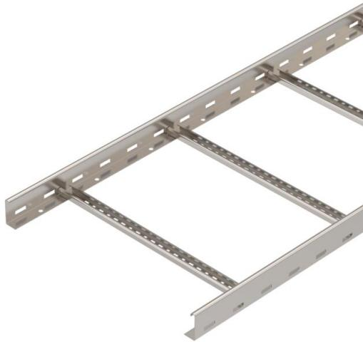
Échelle à câbles avec longeron perforé d'une hauteur de 60 mm, avec échelons VS rivetés (profilé en C) ouverts vers le haut. L'échelle à câbles est livrée repliée.
