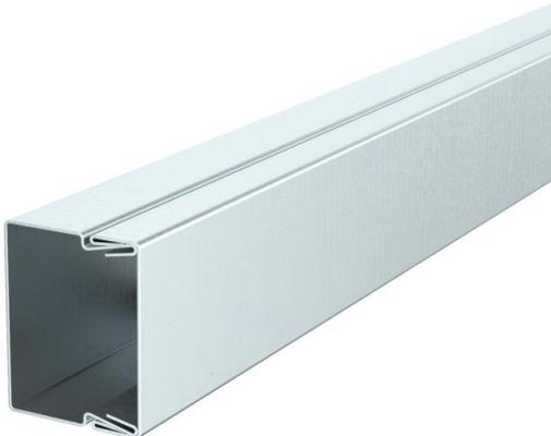
Couvercle et socle de goulotte avec fond perforé. La liaison équivalente est assurée sans accessoire supplémentaire entre le couvercle et le socle. La goulotte de distribution LKM de type LKM 20030 a été testée comme système de pose pour le maintien en fonction selon DIN 4102 partie 12. Veuillez prendre en considération les types de câbles testés destinés au domaine des systèmes de protection anti-incendie BSS.
