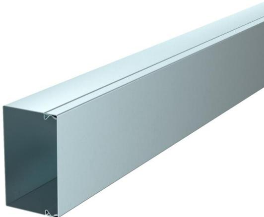
Couvercle et socle de goulotte avec fond perforé. La liaison équivalente est assurée sans accessoire supplémentaire entre le couvercle et le socle. La goulotte de distribution LKM de type LKM 60100 a été testée comme système de pose pour le maintien en fonction selon DIN 4102 partie 12. Veuillez prendre en considération les types de câbles testés destinés au domaine des systèmes de protection anti-incendie BSS.
