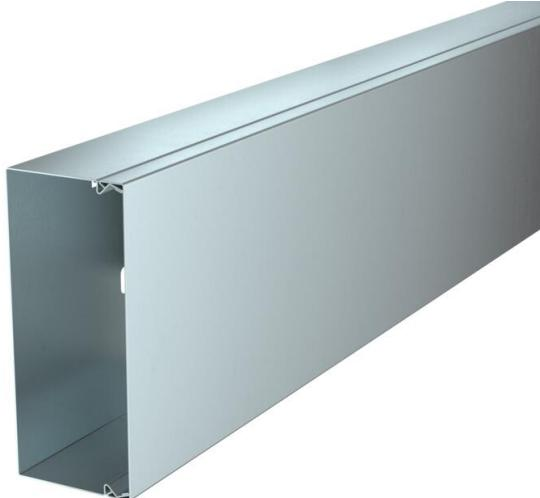
Couvercle et socle de goulotte avec fond perforé. La liaison équipotentielle est assurée sans accessoire supplémentaire entre le couvercle et le socle. Le fond comporte une boucle perforée servant à la fixation du séparateur.
