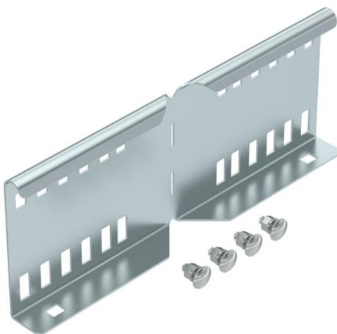
Raccord coudé utilisé comme raccord extérieur pour l'éclissage d'échelles à câbles et de pièces de forme d'une hauteur latérale de 110 mm et avec perforation constante de longeron.
