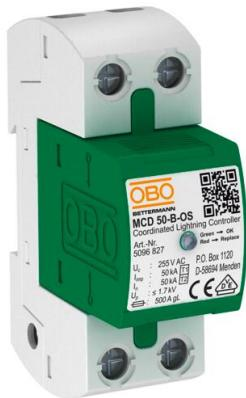
MCD 50-B-OS: Parafoudre coordonné de type 1+2 selon EN 61643-11 avec affichage de la fonction. Pour interface 0 à 2 (LPZ) conformément au concept des zones de protection contre la foudre selon CEI 61312-1 ou DIN VDE 0185-305.
