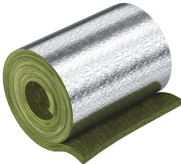
Natte de laine de roche doublée d'aluminium pour gaines isolantes de tubes en cuivre et en acier. Fixation de gaine isolante avec fil de bobinage, sécuriser les joints avec ruban adhésif en aluminium.
