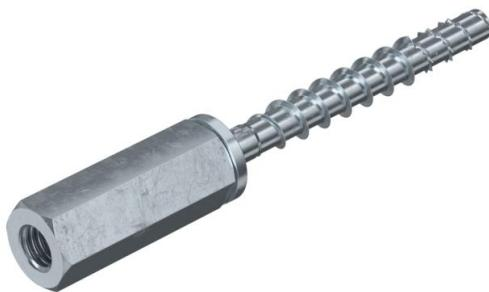
Vis d'ancrage pour le montage direct sans cheville dans la maçonnerie et le béton fissuré et non fissuré. Avec manchon fileté combiné M8/M10 pour la fixation de tiges filetées.
