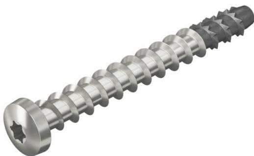
Vis d'ancrage en acier inoxydable pour le montage direct sans cheville dans de la maçonnerie et du béton fissuré et non fissuré. À tête ronde pour des fixations universelles dans les pièces humides et à l'extérieur. Entrainement Torx T30. Produit de construction avec Évaluation Technique Européenne (ETE) et certificat de conformité, certifié CE et conforme aux documents d'évaluation européens. Capacités de charge avec charge thermique jusqu'à la classe de résistance au feu R120 certifiées.
