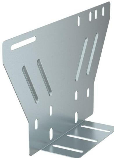
Plaque de montage universelle pour la fixation de la série FireBox T à l'arrière des chemins de câbles en treillis ainsi que des échelles de câbles avec une hauteur latérale max. de 60 mm. Permet un montage sûr du câble de sécurité de fonctionnement, sans que le câble ne doive être plié sur l'aile. Compatible avec toutes les FireBox.
