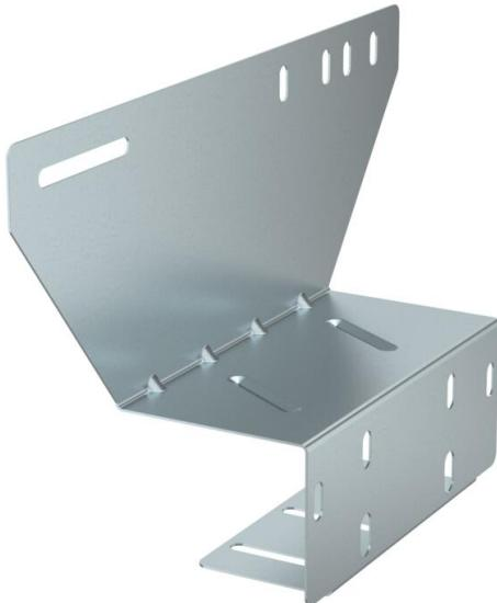
Plaque de montage universelle pour la fixation de la série FireBox T à l'avant des chemins de câbles en treillis ainsi que des échelles de câbles avec une hauteur latérale max. de 60 mm. Permet un montage sûr du câble de sécurité de fonctionnement, sans que le câble ne doive être plié sur l'aile. Compatible avec toutes les FireBox.
