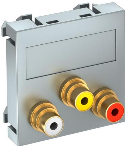
Support multimédia avec trois prises de raccordement Cinch pour audio-vidéo, sortie de câbles droite, avec champ d'inscription, trois raccordements Cinch (RCA) en version femelle-femelle, code couleur jaune/rouge/blanc. Plaque-support avec fixation à encliquer, adaptée au montage horizontal et vertical dans l'environnement du système.
