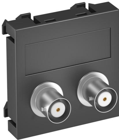
Support multimédia avec deux prises de raccordement BNC pour audio-vidéo, sortie de câbles droite, avec zone de marquage, deux raccordements BNC en version femelle-femelle. Plaque-support avec fixation à encliquer, adaptée au montage horizontal et vertical dans l'environnement du système.
