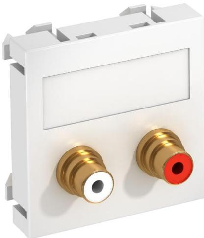
Support multimédia avec deux prises de raccordement Cinch pour audio R/L, sortie de câbles droite, avec zone de marquage, deux prises Cinch (RCA) avec raccord soudé, code couleur rouge/blanc. Plaque-support avec fixation à incliquer, adaptée au montage horizontal et vertical dans l'environnement du système.
