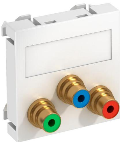
Support multimédia avec trois prises de raccordement Cinch pour Component Video, sortie de câbles droite, avec champ d'inscription, trois raccordements Cinch (RCA) en version femelle-femelle, code couleur rouge/vert/bleu. Plaque-support avec fixation à encliquer, adaptée au montage horizontal et vertical dans l'environnement du système.
