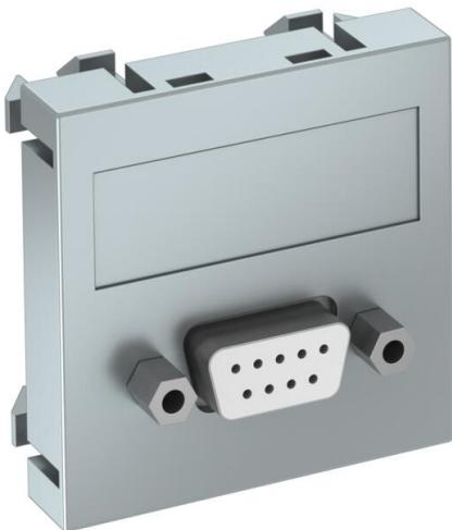
Support multimédia avec une prise de raccordement D-Sub9, sortie de câbles droite, avec champ d'inscription, prise D-Sub9 (RS232) avec raccord à vis. Plaque-support avec fixation à encliquer, adaptée au montage horizontal et vertical dans l'environnement du système.
