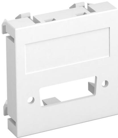
Support multimédia pour un connecteur enfichable DVI, sortie de câbles droite, avec champ d'inscription, sans connecteur enfichable. Plaque-support avec fixation à encliquer, adaptée au montage horizontal et vertical dans l'environnement du système.
