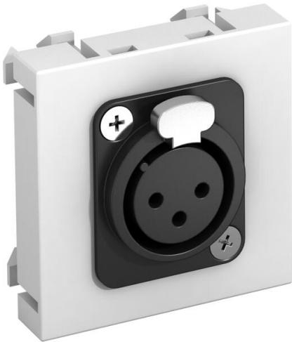
Support multimédia avec une prise de raccordement XLR, sortie de câbles droite, sans champ d'inscription, prise XLR à 3 pôles avec raccord soudé. Plaque-support avec fixation à encliquer, adaptée au montage horizontal et vertical dans l'environnement du système.
