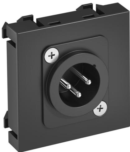
Support multimédia avec une prise de raccordement XLR, sortie de câbles droite, sans champ d'inscription, fiche XLR à 3 pôles avec raccord soudé. Plaque-support avec fixation à encliquer, adaptée au montage horizontal et vertical dans l'environnement du système.
