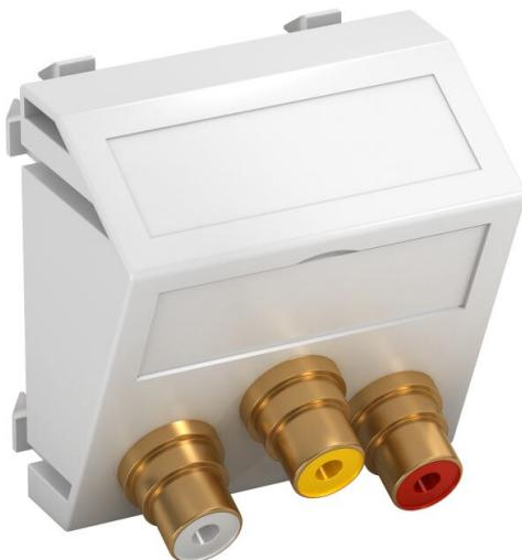
Support multimédia avec trois prises de raccordement Cinch pour audio-vidéo, sortie de câbles oblique, avec zone de marquage, trois prises Cinch (RCA) avec raccord soudé, code couleur jaune/rouge/blanc. Plaque-support avec fixation à encliquer, adaptée au montage horizontal et vertical dans l'environnement du système.
