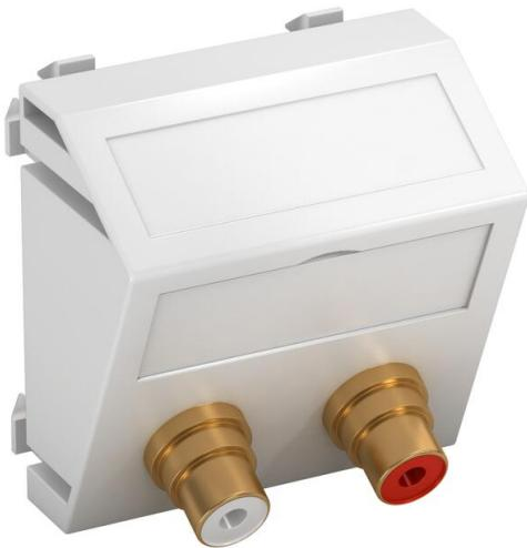
Support multimédia avec deux prises de raccordement Cinch pour audio R/L, sortie de câbles oblique, avec champ d'inscription, deux raccordements Cinch (RCA) en version femelle-femelle, code couleur rouge/blanc. Plaque-support avec fixation à encliquer, adaptée au montage horizontal et vertical dans l'environnement du système.
