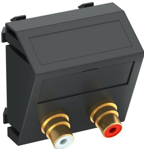
Support multimédia avec deux prises de raccordement Cinch pour audio R/L, sortie de câbles oblique, avec zone de marquage, deux prises Cinch (RCA) avec raccord soudé, code couleur rouge/blanc. Plaque-support avec fixation à incliquer, adaptée au montage horizontal et vertical dans l'environnement du système.
