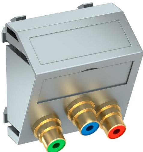
Support multimédia avec trois prises de raccordement Cinch pour Component Video, sortie de câbles oblique, avec champ d'inscription, trois raccordements Cinch (RCA) en version femelle-femelle, code couleur rouge/vert/bleu. Plaque-support avec fixation à encliquer, adaptée au montage horizontal et vertical dans l'environnement du système.
